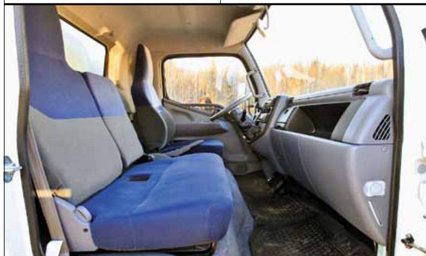
Fuso Canter стал одним из первых среднетоннажников с расположенным на панели приборов рычагом КП, то есть свободным выходом из любой двери
