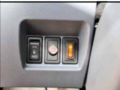
Одна из клавиш задействована на электропривод гидроборта
