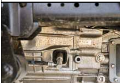
Рабочий цилиндр сцепления расположен внутри картера
