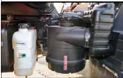
Для автономного подогревателя предусмотрен свой топливный бачок
