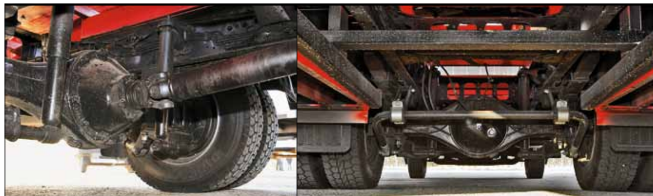
Ведущий мост типа «банджо» удобен съемным в сборе редуктором. Балка моста штамповано-сварная
