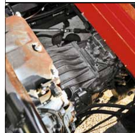
Российский Fuso Canter оснащают 6-ступенчатой коробой передач
