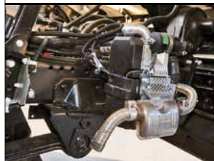
Автономный подогреватель снимает все проблемы зимнего пуска мотора
