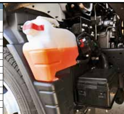
Бачок стеклоомывателя удобно расположен на брызговике кабины
