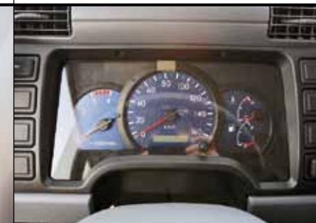
Щиток приборов предельно упрощен – сразу видно, что пневматики нет
