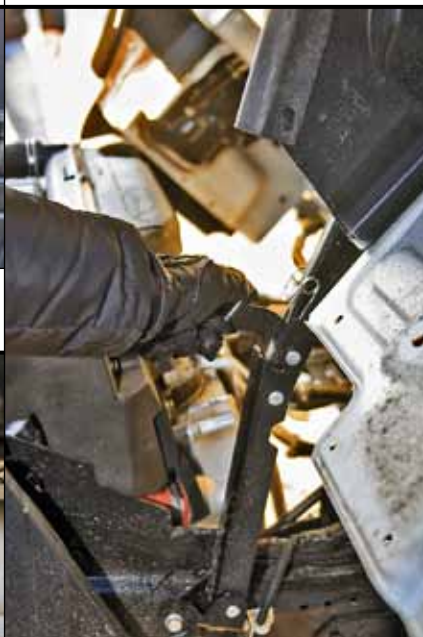
Чтобы никого не придавило кабиной, шарнир штанги блокируется
